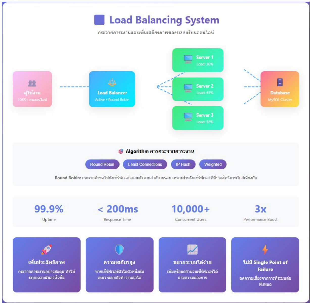
รูปที่ ๑. แนวคิดการนำเทคนิค Load Balancing มาใช้เพื่อกระจายภาระงาน
